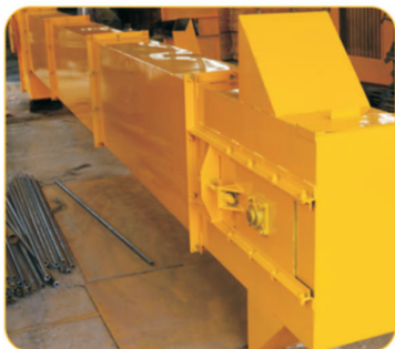
提升机 BUCKET ELEVATOR
